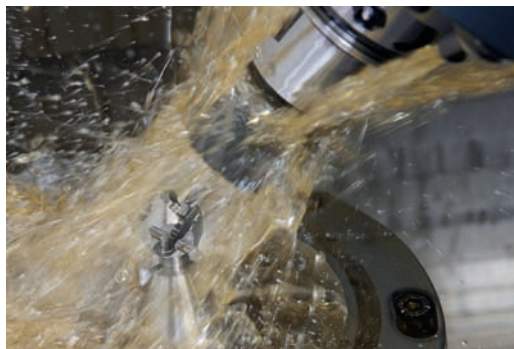
» Opération de forage avec l'huile Blasomill
