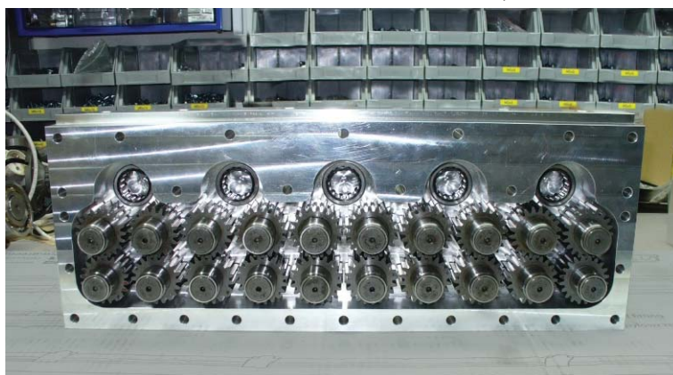
Rekonstrukce větveného převodu náhonové skříně
