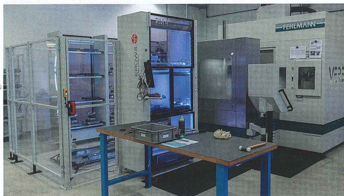
Die Roboter-Anlage ist 24 Stunden in Betrieb und bestückt die 5-Achs-Fräsmaschine Fehlmann P825 Versa. Die Anlage ist modular aufgebaut und kann bei Bedarf ausgebaut werden.
