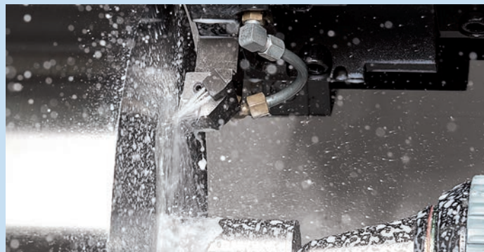
Drehoperation mit wassermischbarem KSS.
