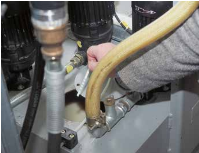
2 Wolfgang Rehm prüft vor Ort regelmäßig die Qualität sowie die Konzentration der KSS-Emulsion, um Anpassungen gezielt und in der richtigen Dosierung vornehmen zu können (© Hanser)
