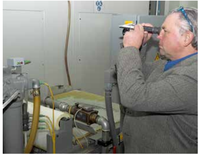
2 Wolfgang Rehm prüft vor Ort regelmäßig die Qualität sowie die Konzentration der KSS-Emulsion, um Anpassungen gezielt und in der richtigen Dosierung vornehmen zu können (© Hanser)
