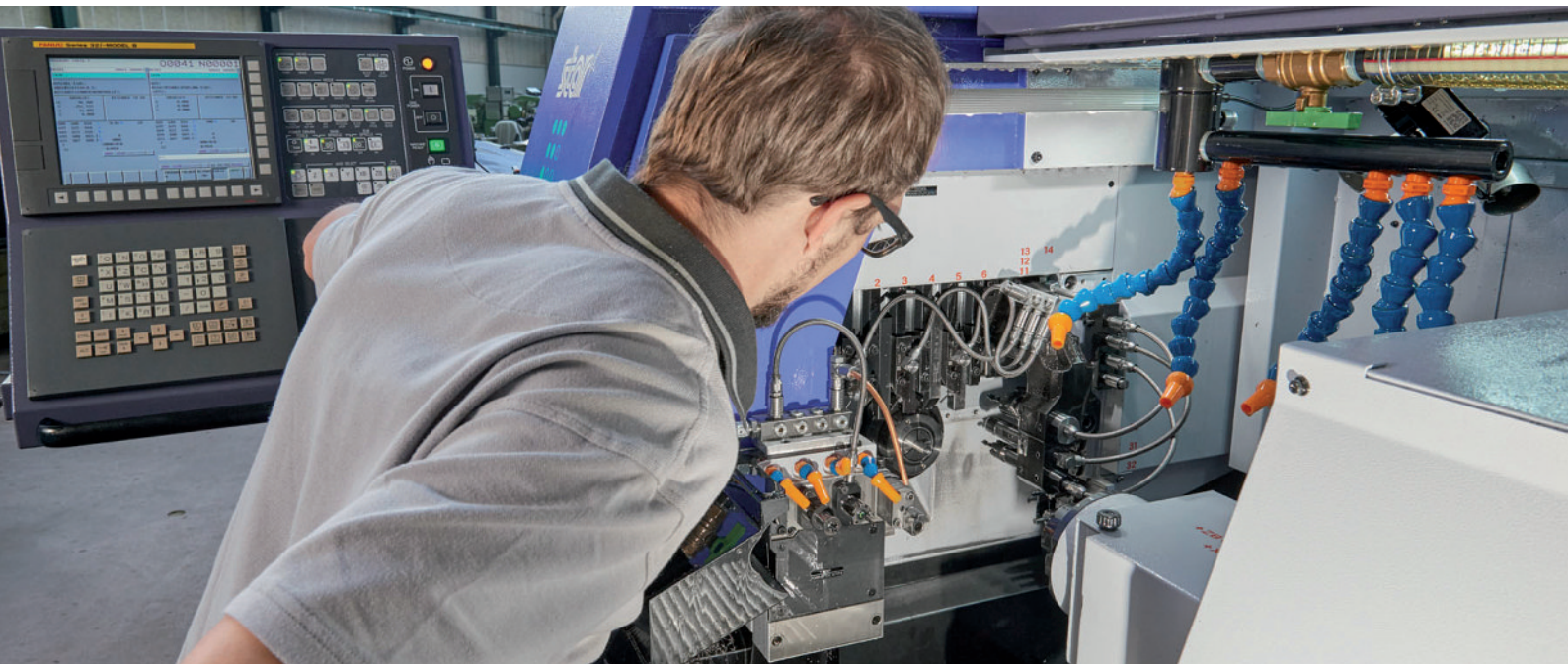
Ohne den richtigen KSS geht gar nichts – ein Mitarbeiter von Ifanger beim Einrichten eines Langdrehautomaten. (Bilder: Blaser)
