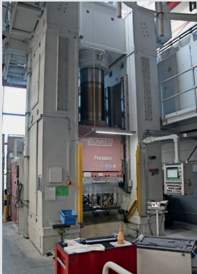
Für das Fließpressverfahren kommen bei alutec Pressen mit einer Presskraft von 1.250 t zum Einsatz.
