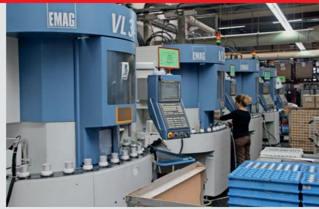
Etwa 60 Maschinen kommen für die Nachbearbeitung der Teile zum Einsatz. Für die KSS-Versorgung sorgt unter anderem eine 3.000-l-Zentralanlage.
